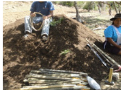
Estacas, hilo de albañil, wincha y cal apagada
