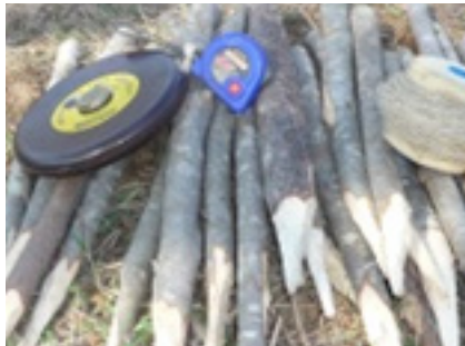
Estacas, hilo de albañil, wincha y cal apagada
