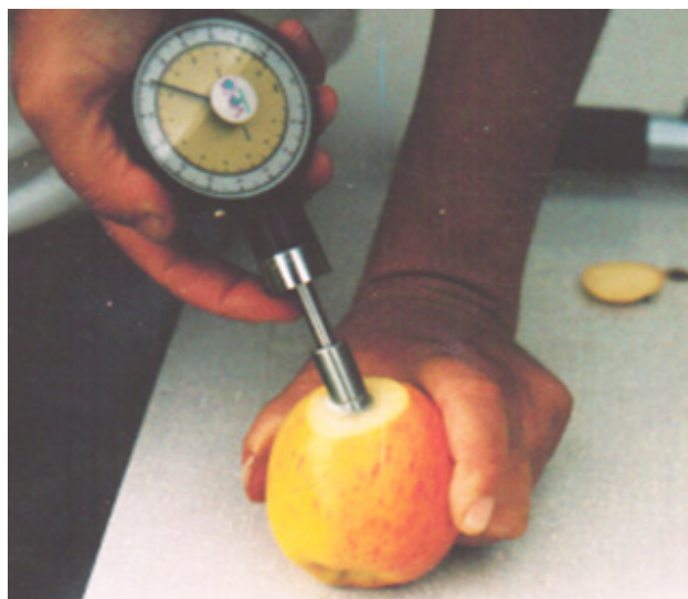
Evaluación de la presión de la pulpa de manzana con penetrómetro
